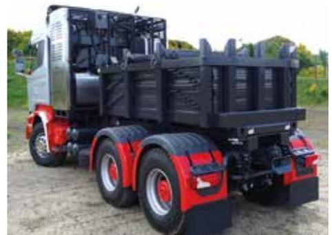
MONTAGE DE LEST AVEC TWIST LOCKS ET CROCHET ARRIÈRE
